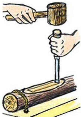
Per realizzare correttamente una mortasa a sezione rettangolare occorre fare un intaglio "piano" (méplat) nella sua posizione. Tracciare con la matita sul méplat la lunghezza e la larghezza della mortasa. Bucare costa a costa dei fori al diametro della larghezza. Terminare la mortasa con lo scalpello.
