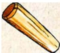
Tagliare un cavichio, con una forma leggermente conica, in modo che occupi al massimo il foro effettuato precedentemente (optare per un cavichio in legno duro, secco e scortecciato).
