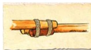
C'è anche un altro sistema (v. figura). Procedendo in questo modo, non dimenticare di intercalare una o due zeppe per evitare oscillazioni.
